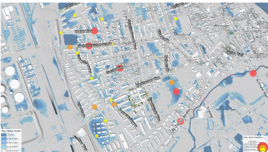
Überfordertes Kanalnetz während eines Starkregenereignisses. Die gekoppelte Simulation liefert Information über Kanalüberläufe.
