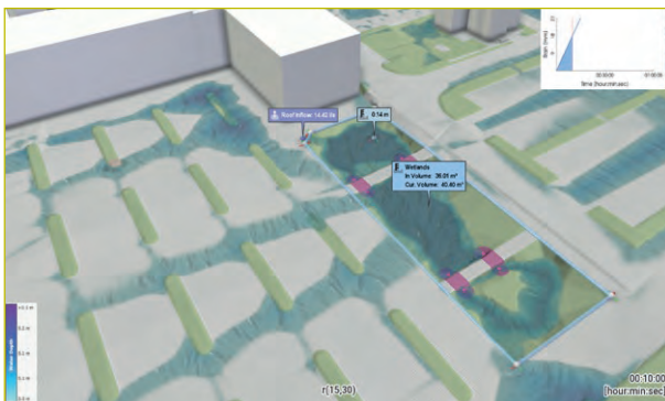
Simulation der Retentionswirkung von geplanten Feuchtgebieten auf einem städtischen Grundstück unter Verwendung einer hohen Rasterauflösung von 25 cm.
